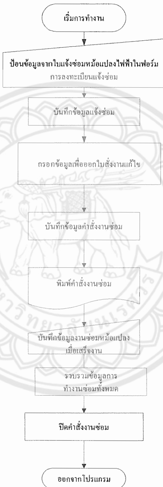
รูปภาพที่ 4.31 แสดงการทำงานของระบบสั่งงานซ่อมแซมและบำรุงรักษาหม้อแปลงไฟฟ้า
