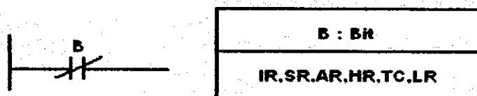
รูปที่ 2.12 คำสั่ง LOAD NOT – LD NOT
