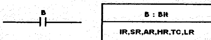
รูปที่ 2.12 คำสั่ง LOAD NOT – LD NOT
