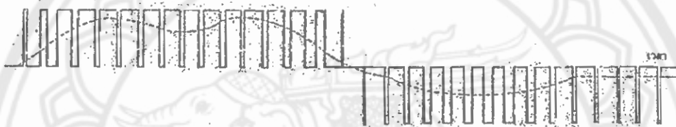
รูปที่ 2.17 รูปคลื่น PWM ที่สวิงระหว่าง +E ถึง ศูนย์ หรือ -E ถึง ศูนย์ เมื่อใช้ทรานซิสเตอร์สองตัวทำงานแบบบริดจ์
