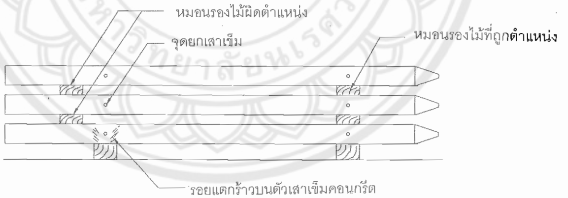
รูปที่ 2.7 การวางหมอนไม้รองเสาเข็มคอนกรีตหล่อสำเร็จ
