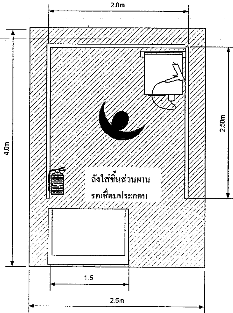
รูปที่ 4.44 พื้นที่การทำงานและอุปกรณ์เชื่อมประกอบผาน( สถานีงานที่ 18 )
