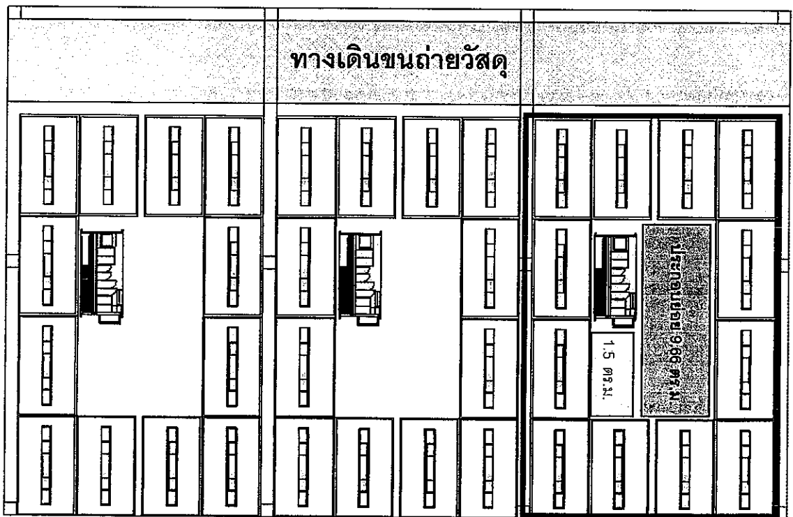
รูปที่ 4.5 แบบของสถานีงานใหม่ (แบบที่ 2) มีรถขนถ่ายวัสดุ
