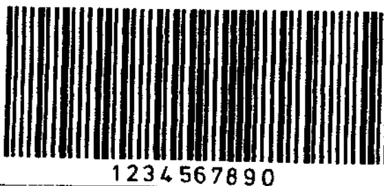
รูปที่ 2.17 Interleaved 2 of 5 พบบ่อยในด้านการขนส่งพัสดุหีบห่อ
