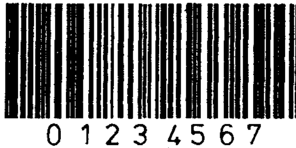
รูปที่ 2.18 Codebar ใช้กันมากในด้านเวชกรรมการแพทย์
