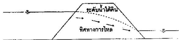
(ข) การไหลของน้ำใต้ดินผ่านเขื่อนดินหรือถนนดินถม หรือสระน้ำ 2 แห่ง
