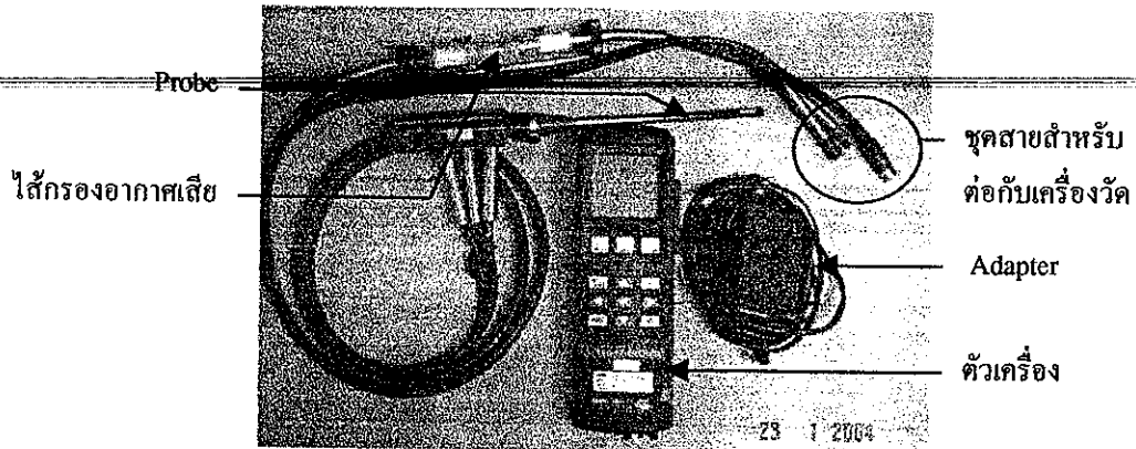
รูปที่ 3.70 แสดงส่วนประกอบของเครื่องวิเคราะห์ไอเสีย
