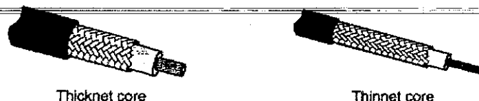
รูปที่ 2.10 สายแบบหนาที่มีแกนกลางหนากว่าสายแบบบาง
