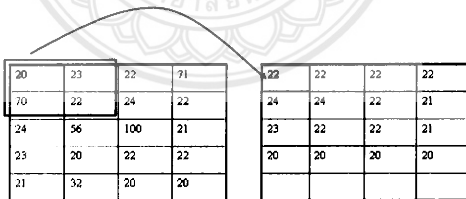
รูปที่ 2.11 แสดงการทำตัวกรองแบบมัธยฐานแบบ 2 \times 2
