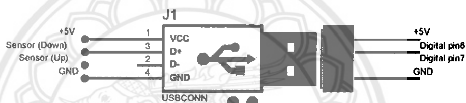
รูปที่ 3.13 การเชื่อมต่อของขาสัญญาณะระหว่างตัวรับรู้ระดับของเหลวกับบอร์ดไมโครคอนโทรลเลอร์อาดูโน ยูโน อาร์3
