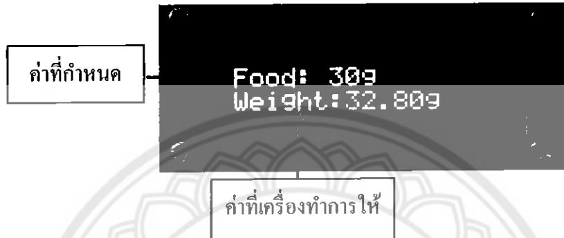
รูปที่ 4.3 น้ำหนักอาหารที่กำหนด กับน้ำหนักอาหารที่เครื่องให้อาหารสัตว์อัตโนมัติทำการให้ ตารางที่ 4.2 ผลการทดลองเปรียบเทียบน้ำหนักอาหารที่กำหนด กับน้ำหนักอาหารที่เครื่องให้อาหารสัตว์อัตโนมัติทำการให้
