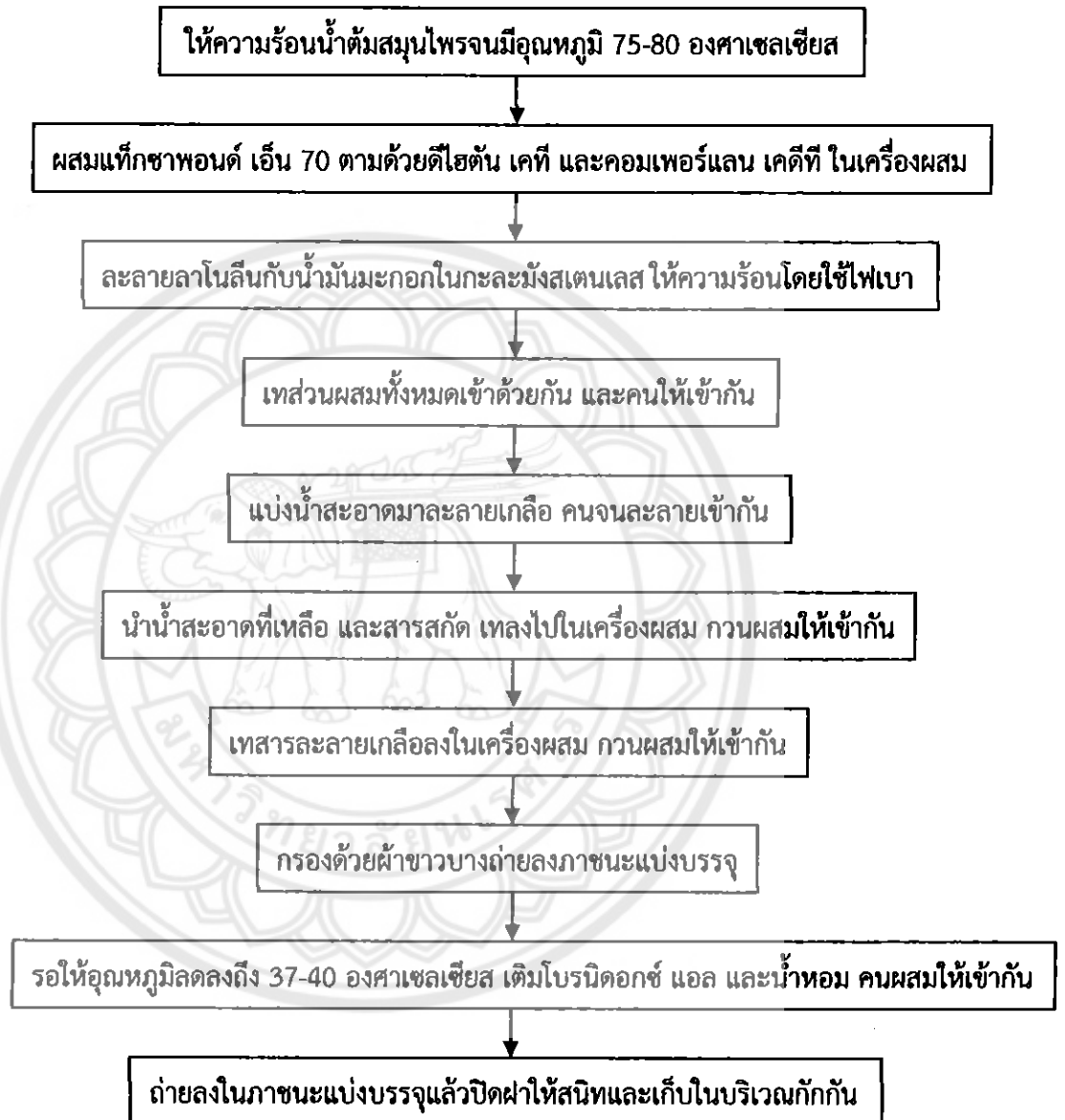
รูปที่ 4.1 แผนภาพแสดงขั้นตอนการผลิตผลิตภัณฑ์สมุนไพรประเภทแชมพู
