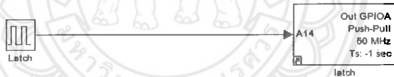
ภาพที่ 3.18 แสดงการ latch ข้อมูลออกไปยังไดโอดเปล่งแสง
