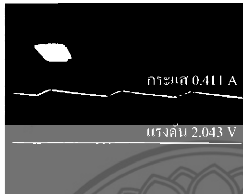
ก) แรงดันปรับตั้ง 4.5 V จำกัดกระแส 0.4 A
