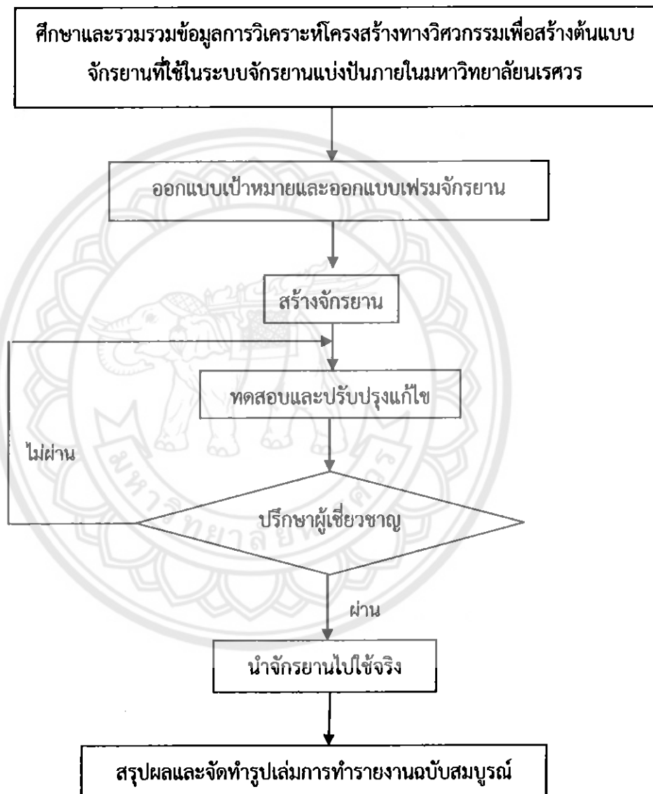
รูปที่ 3.1 ขั้นตอนในการดำเนินโครงการ การวิเคราะห์โครงสร้างทางวิศวกรรมเพื่อสร้างต้นแบบ จักรยานที่ใช้ในระบบจักรยานแบ่งปันภายในมหาวิทยาลัยนเรศวร
