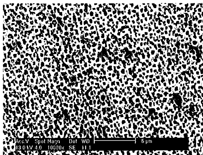
รูปที่ ข.5 ภาพถ่ายโครงสร้างจุลภาคของชิ้นงานโลหะผสมพิเศษเบสนิเกิลเกรด GTD – 111 หลัง ผ่านการทำละลายที่อุณหภูมิ 1185 °C เป็นเวลา 4 ชั่วโมงและผ่านการบ่มแข็งที่อุณหภูมิ 845 °C เป็นเวลา 100 ชั่วโมง
