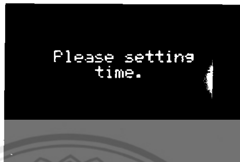
รูปที่ 4.14 แสดงหน้าจอแสดงผลของกล่องควบคุมขณะรอรับคำสั่งในการตั้งเวลาจาก อุปกรณ์อัจฉริยะ
