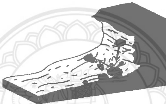
รูปที่ 2 รูปแบบจำลองลักษณะของ Rock fall
