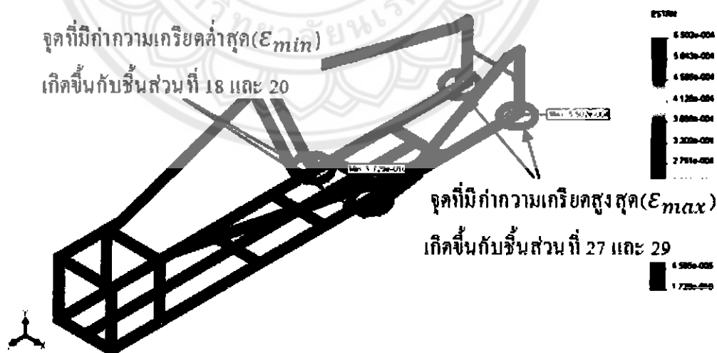
รูปที่ 3.28 ผลการวิเคราะห์แสดงค่าความเครียด (Strain) ของ โครงสร้างแบบที่ 2
