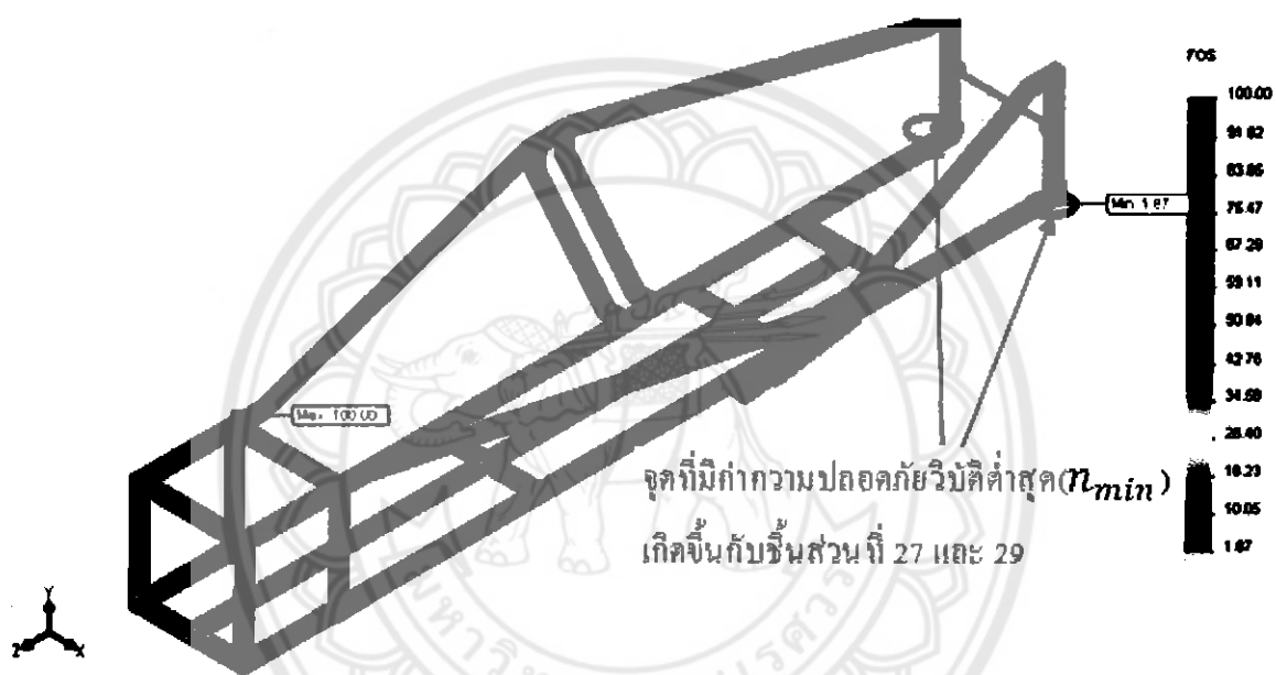
รูปที่ 3.24 ผลการวิเคราะห์ค่าความปลอดภัย (Factor of Safety) ภายในโครงสร้างแบบที่ 1
