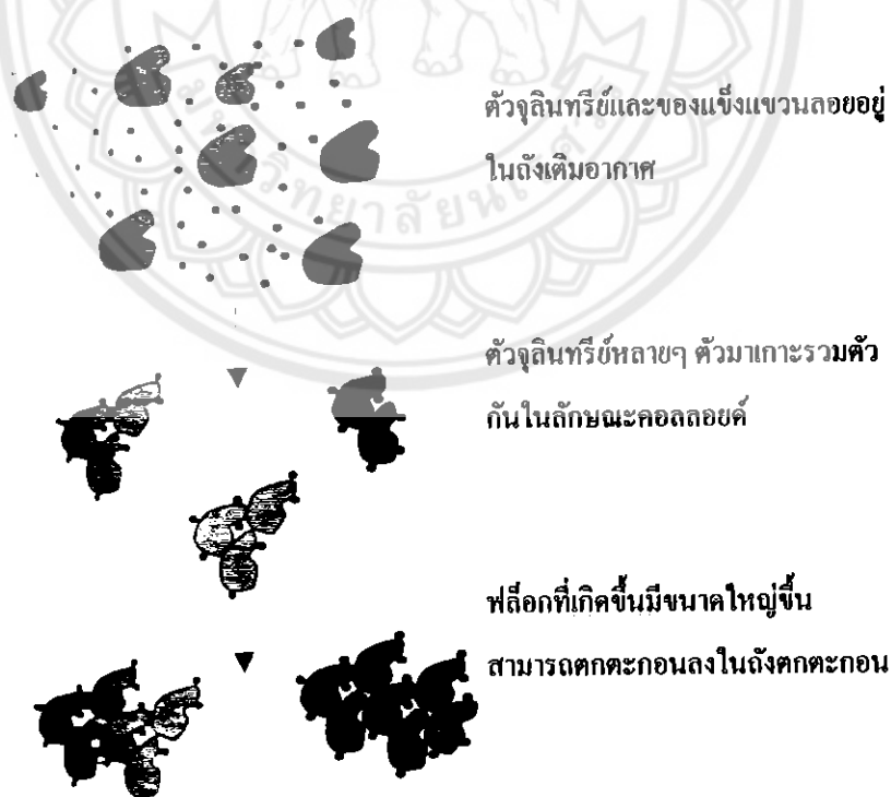
รูปที่ 2.6 แสดงขั้นเกิดฟล็อกในระบบเอเอส
