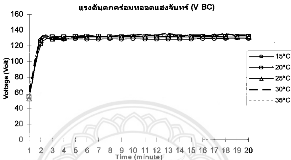
รูปที่ 4.59 แผนภูมิแสดงผลการวัดแรงดันที่ตกคร่อมหลอดแสงจันทร์ที่อุณหภูมิต่างๆ
