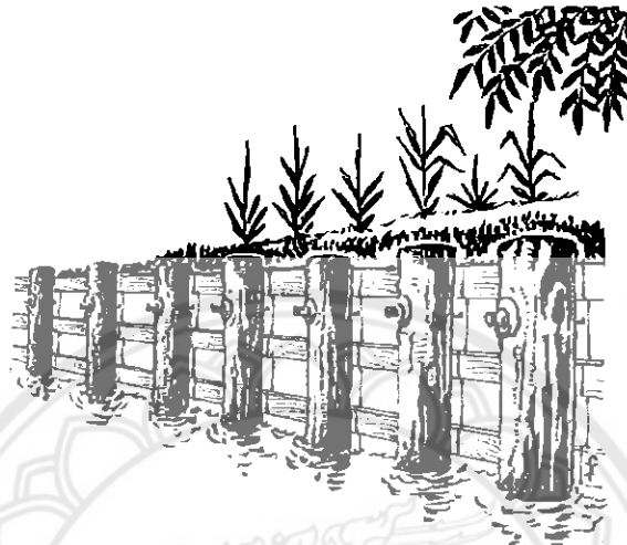
รูปที่ 2.17 เชื่อนป้องกันตลิ่งแบบ Sheet - Piling Wall
