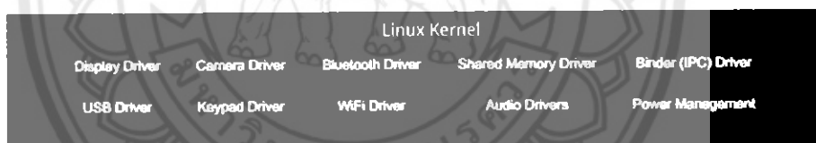
รูปที่ 2.6 สถาปัตยกรรมของการออกแบบแอนดรอยด์ชั้นลินุกซ์เคอร์เนล [6]
