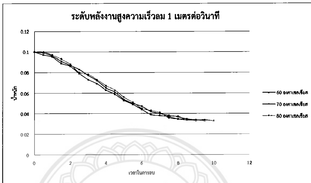
รูปที่ 4.19 กราฟความสัมพันธ์ระหว่างน้ำหนักรของกล้วยกับเวลาในการรอบ ที่ระดับพลังงานสูง ความเร็วลม 1 เมตรต่อวินาที
