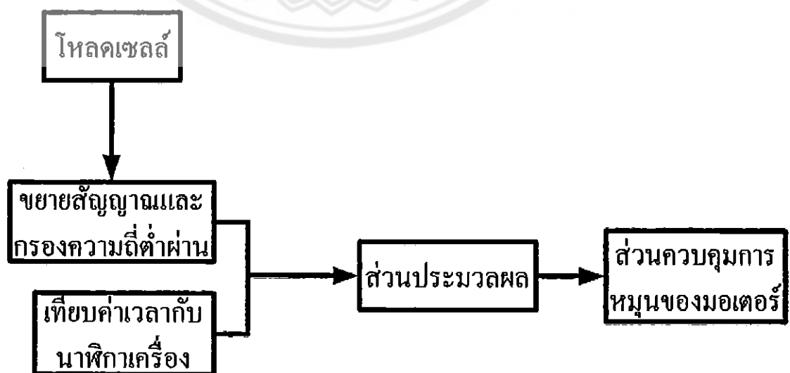
รูปที่ 3.2 แผนภาพแสดงการทำงานทั้งหมด
