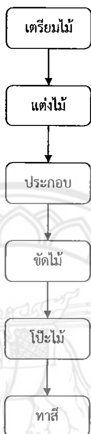
รูปที่ 4.3 แสดงกระบวนการผลิตของเพอร์นิเจอร์ไม้
