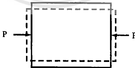
รูปที่ 2.4 แสดงแรงกด (Compression)
