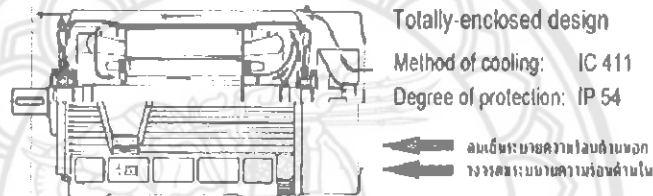
รูปที่ 2.15 แสดงลักษณะการระบายความร้อนของมอเตอร์ [5]
