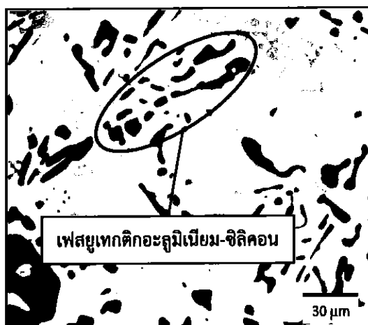
รูปที่ 4.9 (ต่อ) โครงสร้างทางจุลภาคของชิ้นงานสภาพหล่อ และหลังผ่านการอบละลาย ชุบน้ำที่อุณหภูมิ 80 องศาเซลเซียส จากกล้องจุลทรรศน์แบบแสง จ) ชิ้นงานหลังผ่านการอบละลายที่อุณหภูมิ 500 องศาเซลเซียส เป็นเวลา 8 ชั่วโมง
