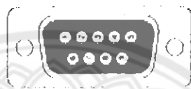
รูปที่ 2.13 DB9 ตัวผู้ เมื่อมองจากด้านหลัง
