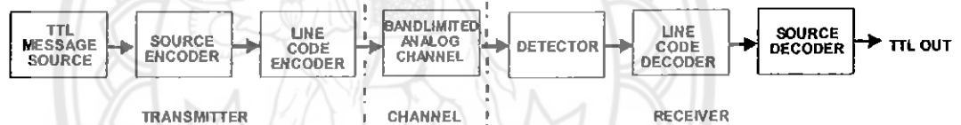
รูปที่ 2.2 ระบบการส่งและรับสัญญาณดิจิทัลแบบเบสแบนด์
