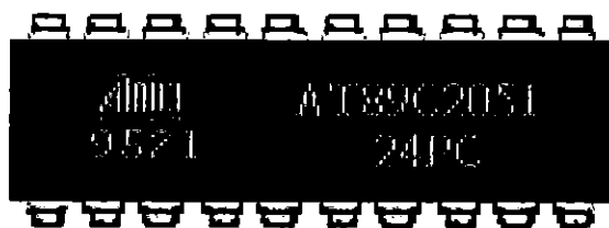
รูป 2.6 ไอซีไมโครคอนโทรลเลอร์ของ ATMEL แบบแฟลชขนาด 20 ขา
