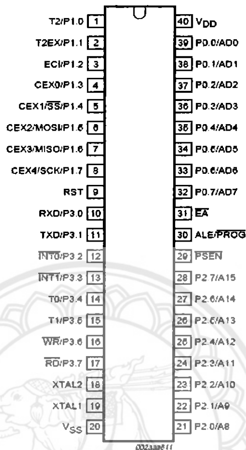
รูปที่ 2.8 ชื่อและตำแหน่งขาของไอซีไมโครคอนโทรลเลอร์ P89V51RD2FNBN
