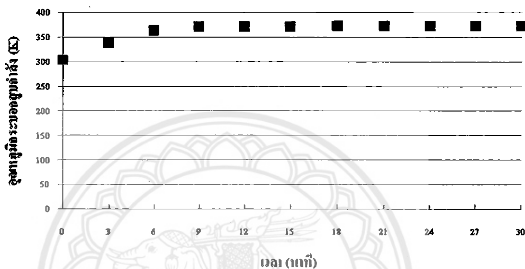
รูปที่ 4.2 ความสัมพันธ์ระหว่างเวลาและอุณหภูมิกระบอกสูบกำลัง ( T_H )
