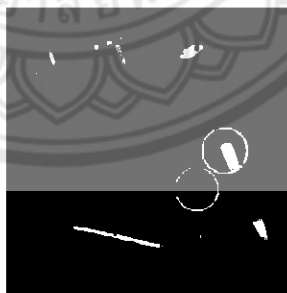
รูปที่ 4.45 ผลลัพธ์ที่ได้หลังจากการรันโปรแกรมโปรแกรมตรวจจับวัตถุวงกลมภายในภาพ จากรูปที่ 4.41
