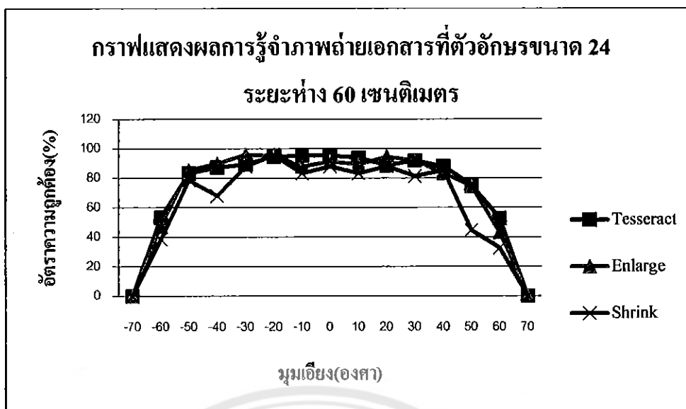
รูปที่ 5.16 กราฟผลการทดสอบการรู้จำที่ตัวอักษรขนาด 24 และระยะห่าง 60 เซนติเมตร
