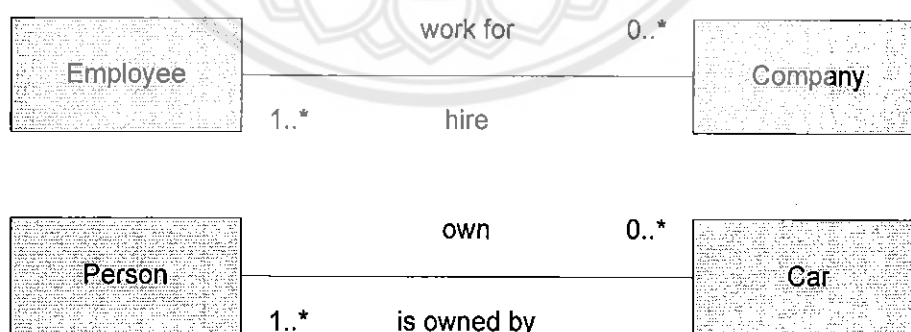
รูปที่ 2.5 ความสัมพันธ์แบบ 2 ทิศทางของ Object หรือ Class แบบ Association
