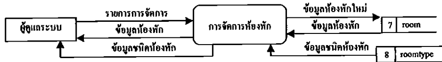
รูปที่ 3.15 แสดง Data Flow Diagram Level 0 ของ การจัดการรายการห้องพัก
