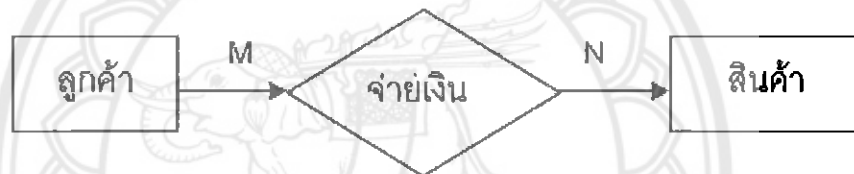
รูปที่ 2.4 ตัวอย่าง E-R diagram แบบ M:N
