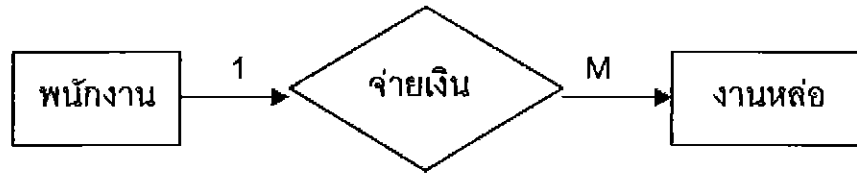
รูปที่ 2.3 ตัวอย่าง E-R diagram แบบ 1:M
