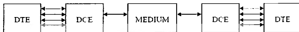
รูปที่ 2.12 แสดงส่วนประกอบของการสื่อสารข้อมูล
