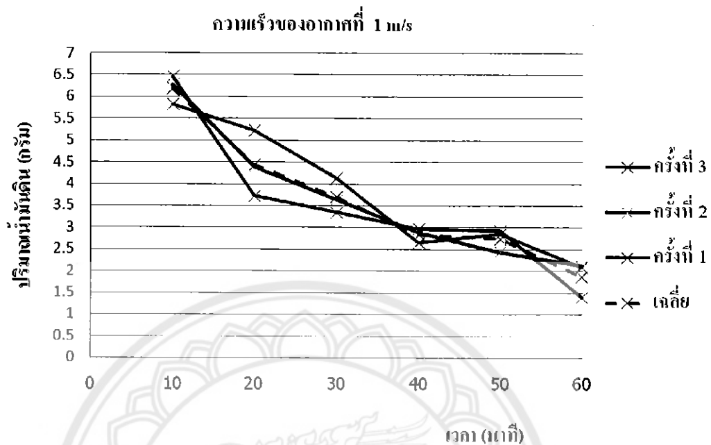
รูปที่ 4.3 ปริมาณน้ำมันดินที่อัตราการไหลของอากาศ 1 m/s แบบ Updraft
