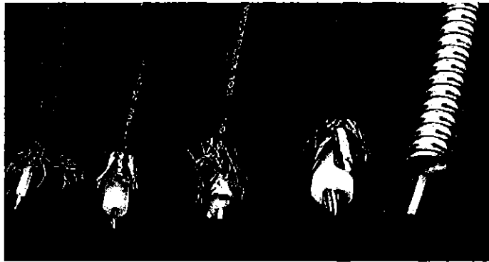
รูปที่ 2.10 สายส่งแบบอิมบาลานซ์ไลน์แต่ละประเภท
