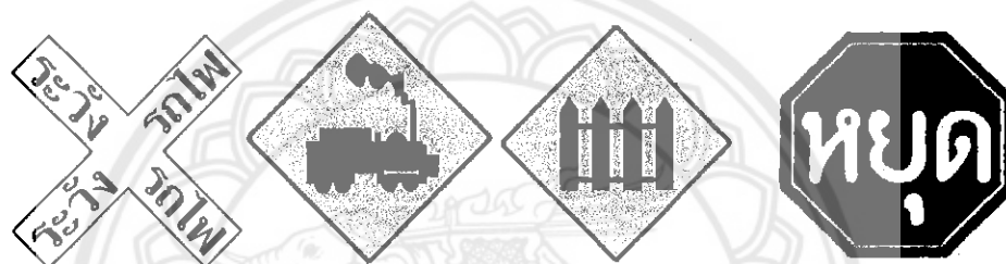
รูปที่ 4.24 ป้ายเตือนที่ติดตั้งบริเวณจุดตัดทางรถไฟ
