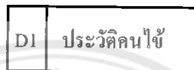
รูปที่ 2.3 ตัวอย่างสัญลักษณ์หน่วยเก็บข้อมูล (Data Store)
