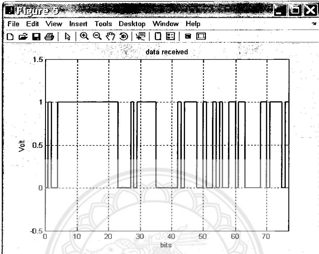
รูปที่ 5.14 แสดงข้อมูลที่เกิดความผิดพลาด 7 บิตติดต่อกันในรูปของสัญญาณพัลส์
