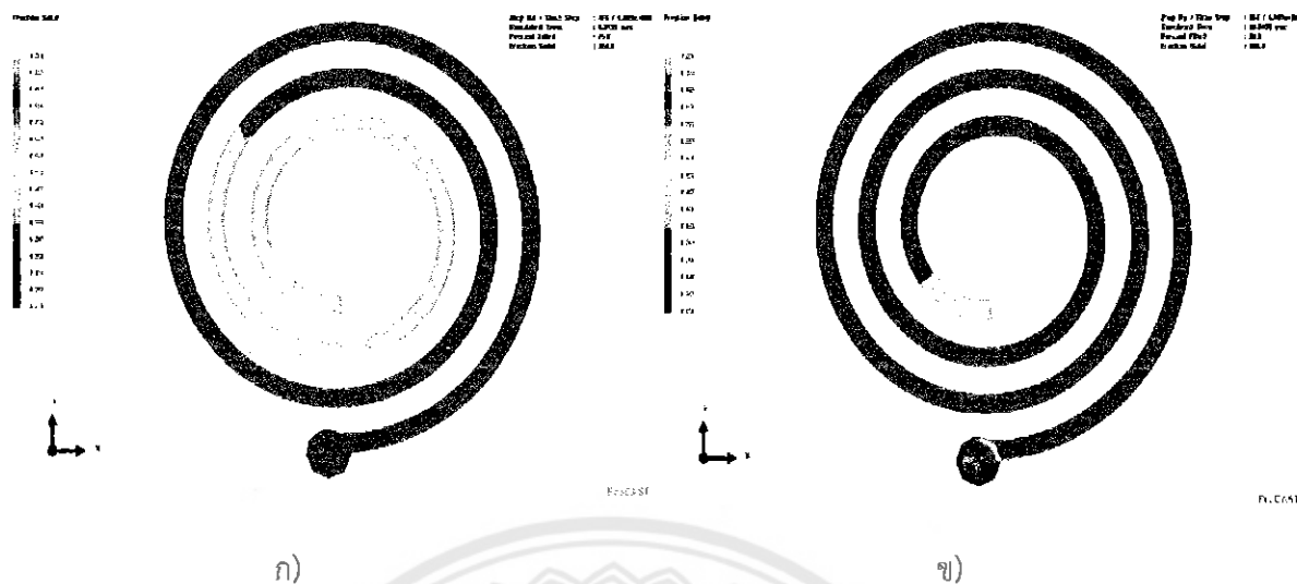
รูปที่ 4.4 เปรียบเทียบผลของดัชนีการไหลของการเปลี่ยนอุณหภูมิเทโดยการหล่อแบบใช้แรงโน้มถ่วง
