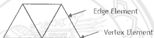
(c) ขอบ และมุมของเมช รูปที่ 4.6 รูปร่างต่าง ๆ ของเมช
