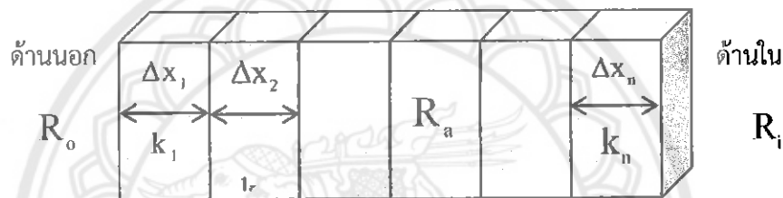
รูปที่ 2.2 สภาพการถ่ายเทความร้อนผ่านผนังและหลังคาอาคาร ซึ่งมีโครงสร้างประกอบขึ้นจากวัสดุแตกต่างกัน n ชนิด และมีช่องว่างอากาศภายใน
