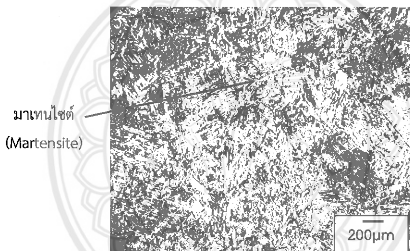
รูปที่ 4.21 โครงสร้างจุลภาคของใบสกรูที่ทำเหล็กคาร์บูไรซิ่งที่ 4 ชั่วโมง ภายหลังจากชุบแข็ง
